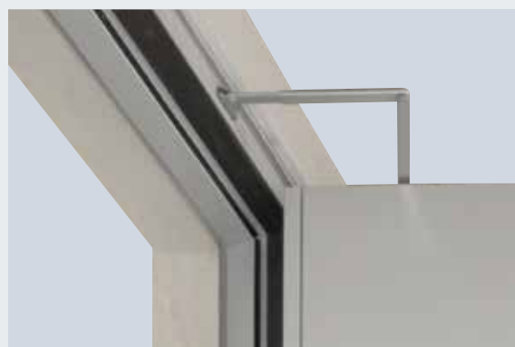
Блочная коробка 140 / 75 мм, сост. из 3 частей, по контуру – с канавкой для уплотнения с 3 сторон
